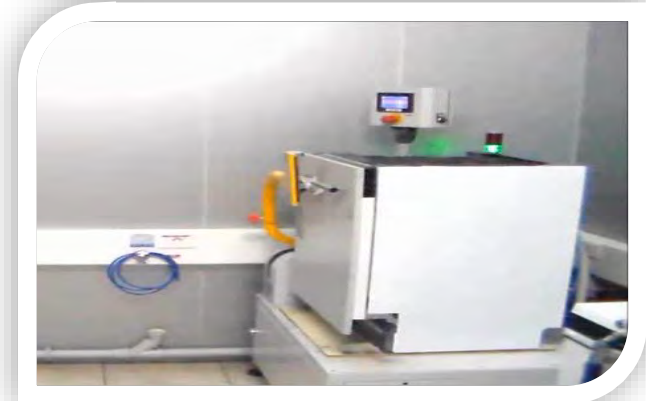
Kapı Ama ve Kapama Test Kurulumu
