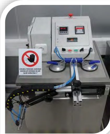
Aık/Kapalı Switch Test Kurulumu
